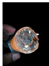
Gambar 4. 3 sensor target patah karena tertabrak metal
