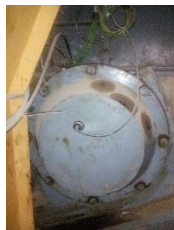
Gambar 4. 4 posisi sensor pada plummer block
