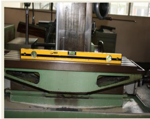
Gambar 1a. Pengukuran Penyelarasan Meja Kerja Arah Memanjang
