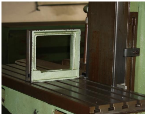
Gambar 1b. Pengukuran Penyelarasan Meja Kerja Arah melintang
