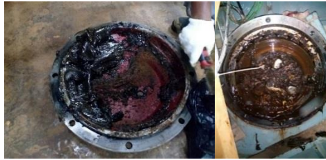
Gambar 4. 1 grease pada plummer block dan metal target
