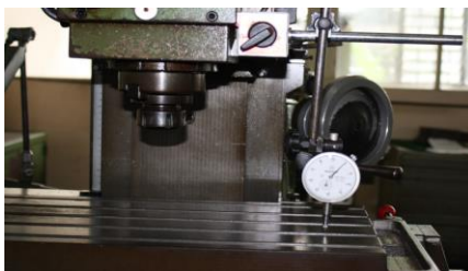
Gambar 5. Pengukuran kedataran permukaan meja kerja
